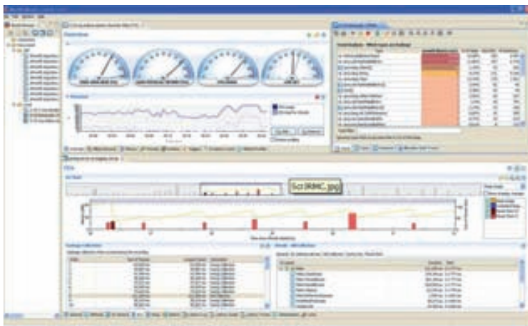
Figure 1. Le tableau de bord JRockit Mission Control offre une perspective en profondeur sur l'exécution de l'application sur le serveur d'applications en utilisant des temps supplémentaires négligeables.
